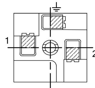
Расположение контактов на розетке разъема со стороны винтового закрепления проводников (Разъем в соответствии с DIN 43650C серии GDM с 3 контактами).
