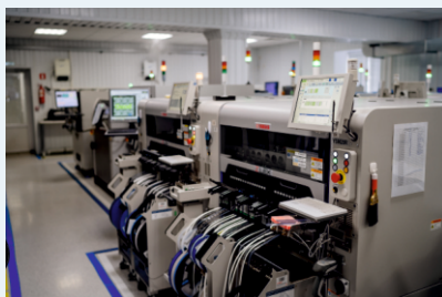
УЧАСТОК ПОВЕРХНОСТНОГО МОНТАЖА
