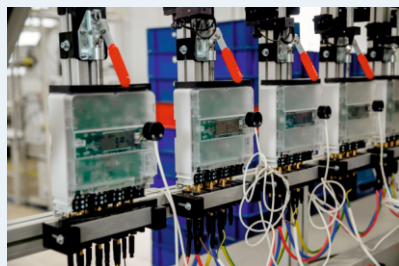
6 УСТАНОВОК ДЛЯ ПОВЕРКИ ЭЛЕКТРОСЧЕТЧИКОВ
