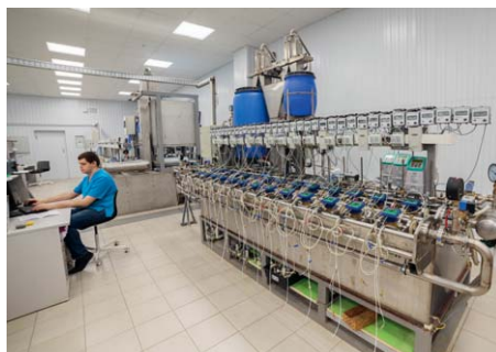
Метрологическая лаборатория оборудована проливными установками для поверки счетчиков воды и тепла Ду15-Ду200
