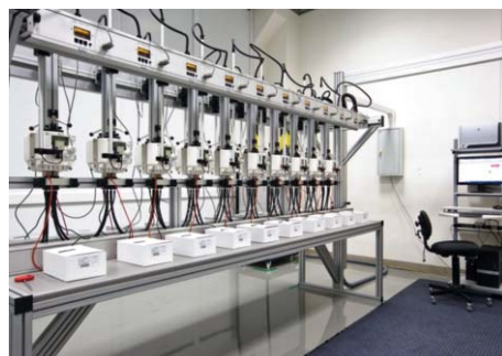
Стенд поверки и тестирования элетросчетчиков
